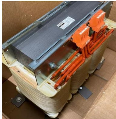
Figura 9. Trasformatore per l'isolamento del sistema di conversione AC-DC verso la rete elettrica.
