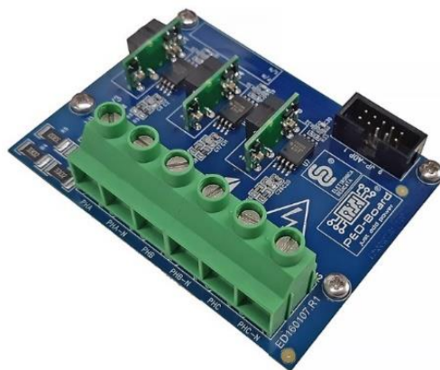
Figura 14. High Voltage Sensing Board per la lettura delle tensioni di rete.
