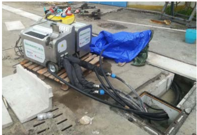
Figura 27. Apparecchiatura strumento GEOgert 2.0 collegata alle sonde geotermiche del pozzo 1 e caratteristiche delle sonde
