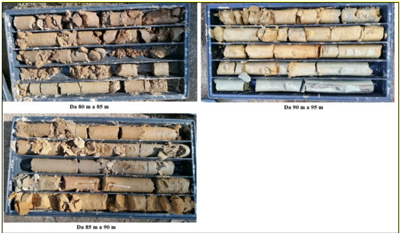
Figura 22. Materiale di carotaggio raccolto in cassette catalogatrici (da 80 m a 90 m)
