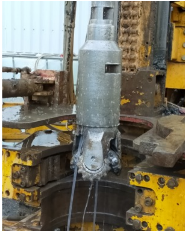
Figura 10. Tipo di tricono usato per l'alesatura del foro fino a 148 mm
