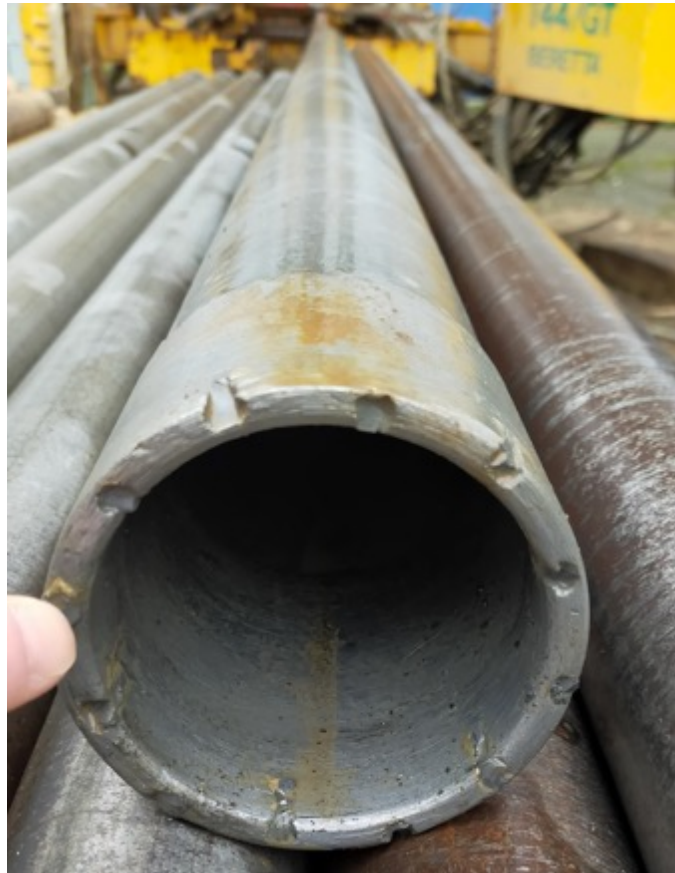
Figura 8. Carotiere per il prelievo del materiale
