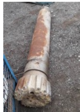
Figura 11. Perforazione ad aria compressa miscelata a schiumogeno e martello fondo foro
