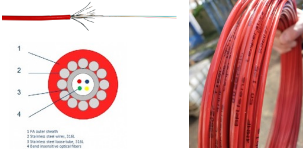
Figura 36. Fibra di tipo DiTeSt Ordinary Temperature Sensing Cable (Smartec)
