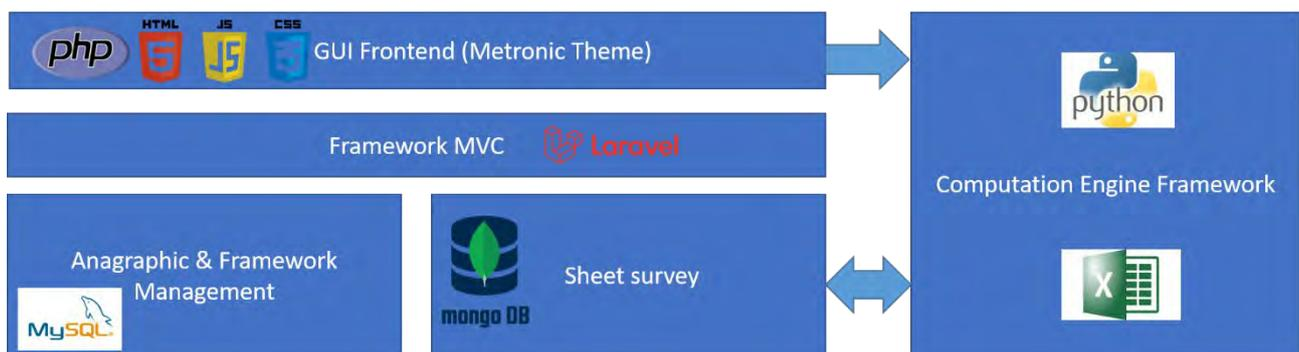
Figura 43. Architettura e stack tecnologico Smart Sim
