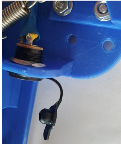
Figura 12 – Dettaglio del connettore Jack per collegare l'alimentatore alla stazione di ricarica
