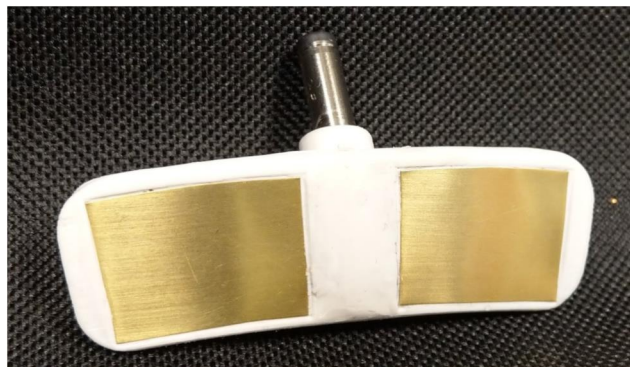
Figura 5 – ROBOTLAB Inc. – Dettaglio del connettore con i terminali di carica da applicare sul dorso del robot (NAO DOCKING STATION)
