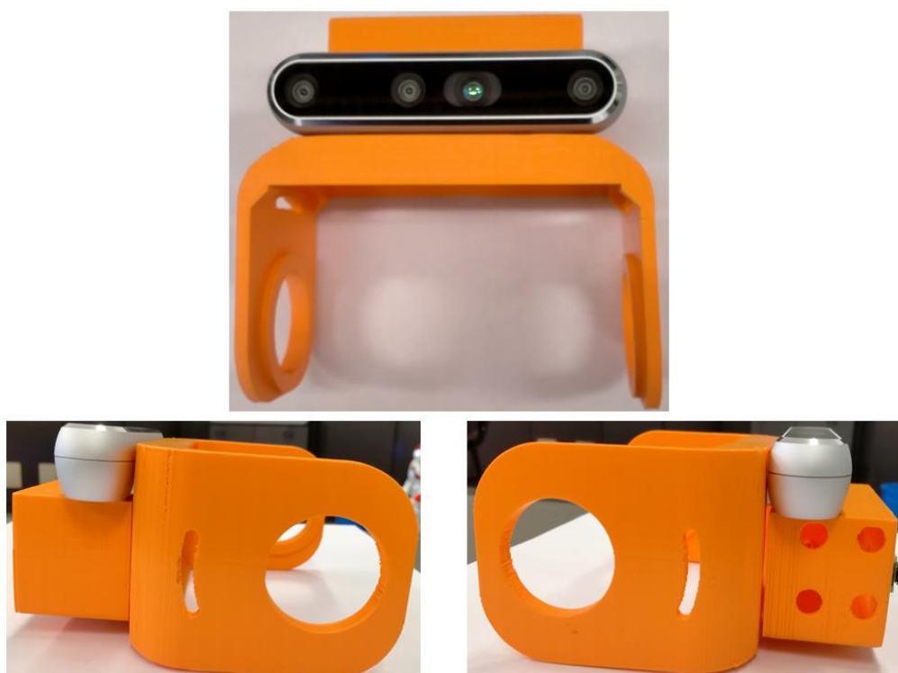
Figura 25 – Vista frontale e laterali del caschetto per l'alloggiamento della Depth Camera RealSense D455
