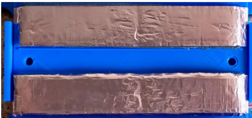
Figura 11 – Dettaglio dei contatti elettrici sulla stazione di ricarica
