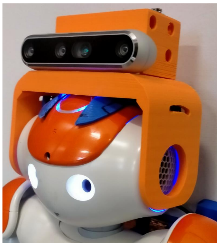
Figura 26 – Caschetto per l'alloggiamento della Depth Camera RealSense D455
