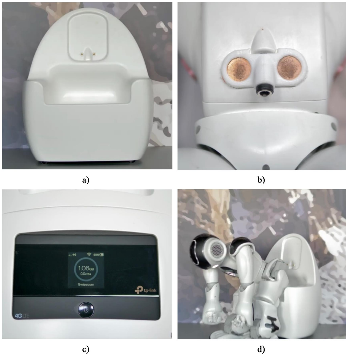
Figura 2 – Robot in ricarica sulla una Docking Station NAO POD (Avatarion Technology AG)
