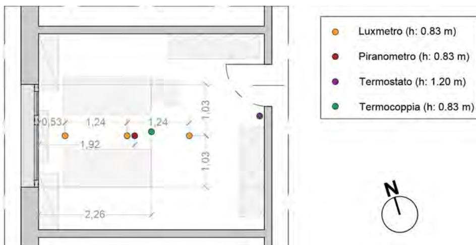
Figura 13: Posizione di luxmetri, piranometro e sensori di temperatura all'interno dell'ufficio (altezza dal pavimento: 0.83 m)
