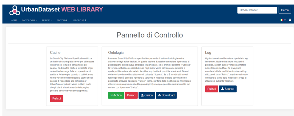
Figura 13 Pagina di controllo del processo di pubblicazione. Si notano i pulsanti pubblica, carica e scarica che implementano le funzionalità descritte nel caso d'uso.
