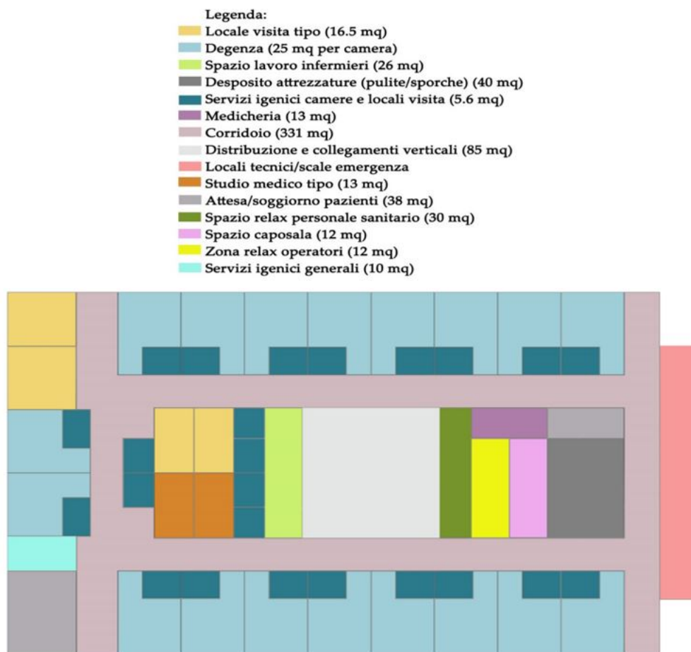
Figura 9: Legenda e planimetria schematica del piano degenza tipo dell'ospedale.
