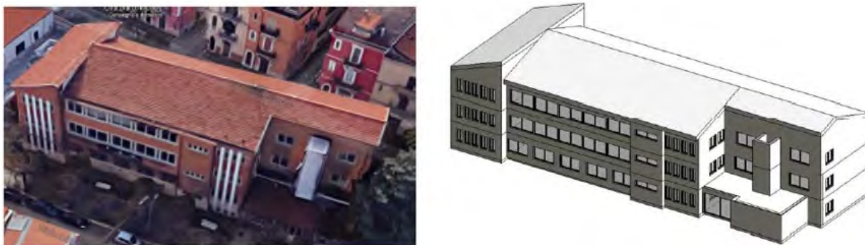
Figura 53. Immagine dell'edificio caso studio (sinistra) e modello architettonico 3D in ambiente BIM (destra)
