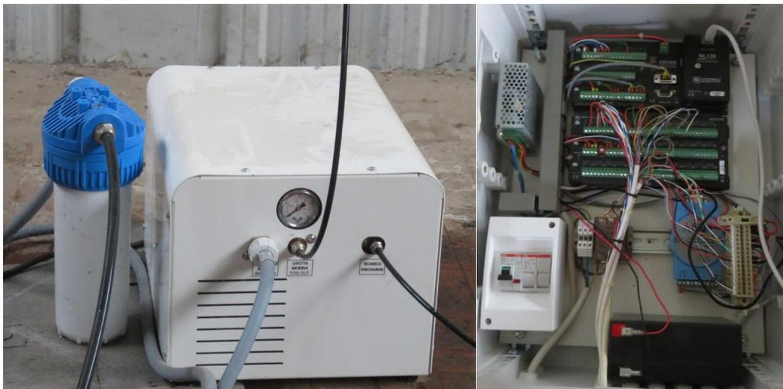
**Figura 26. Pompa di alimentazione idrica (sinistra) e data logger della sensoristica di campo e dell'impianto PV.**
