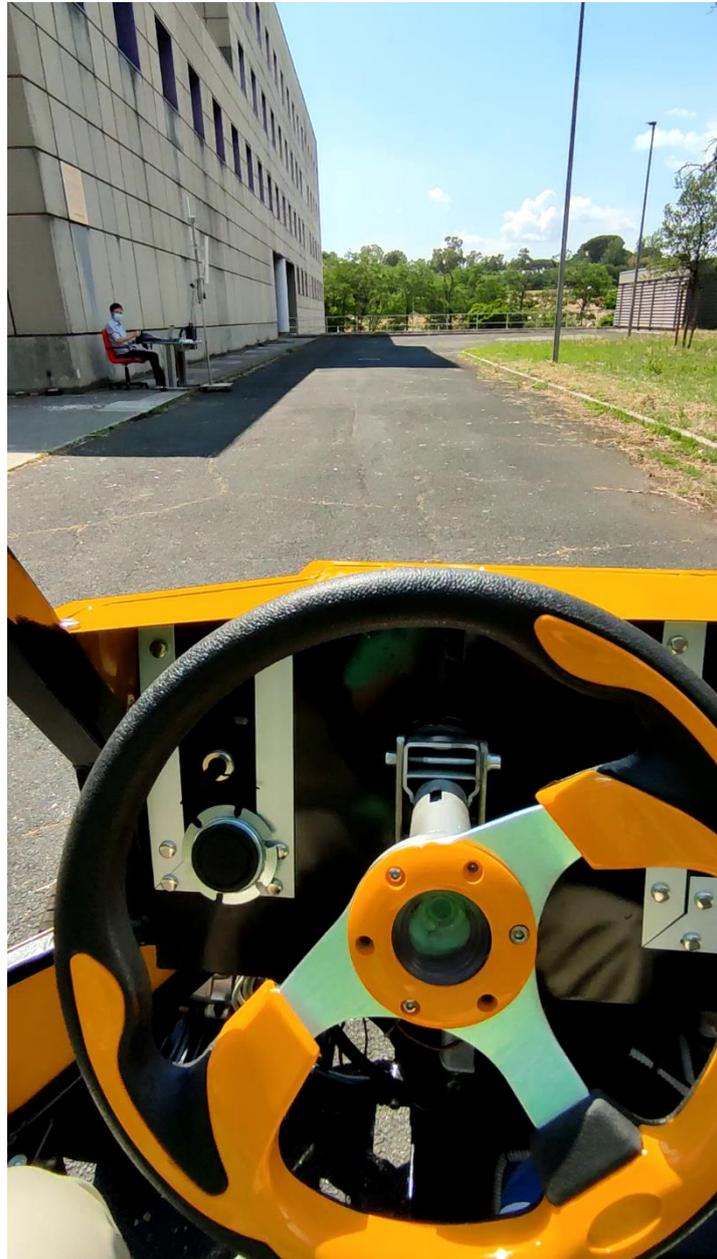
**Figura 9. Il veicolo in teleoperazione, l'operatore è visibile in alto sulla sinistra mentre controlla il veicolo con volante e pedaliera**
