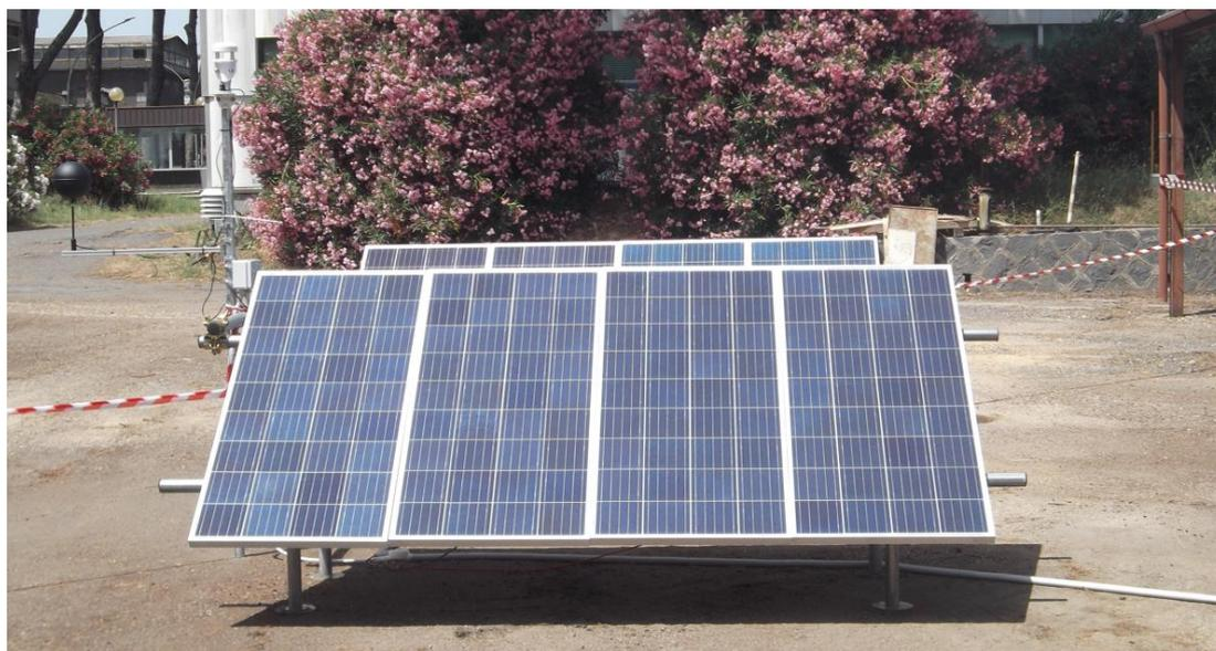
**Figura 27. Dettaglio dei pannelli PV, a sinistra si possono notare i sensori di monitoraggio microclimatico esterno all'impianto di nebulizzazione: termo-igrometro, anemometro, globo-termometro**
