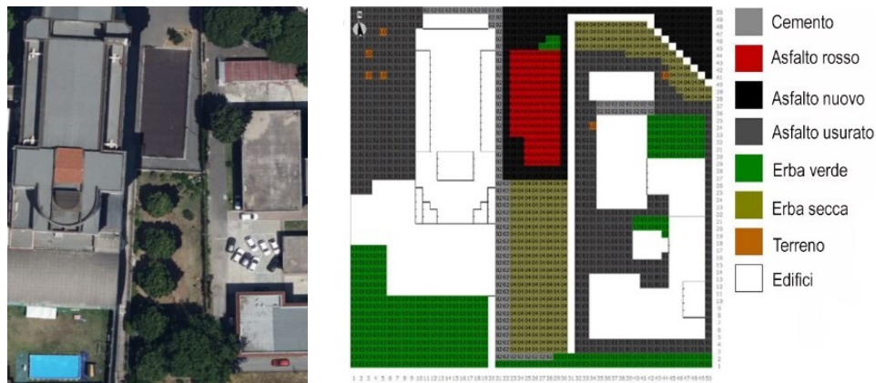
Figura 12 Area modellata, in cui è stato costruito un sistema nebulizzante nell'estate 2018 (sinistra) e pianta con materiali del suolo implementati nel modello (destra)
