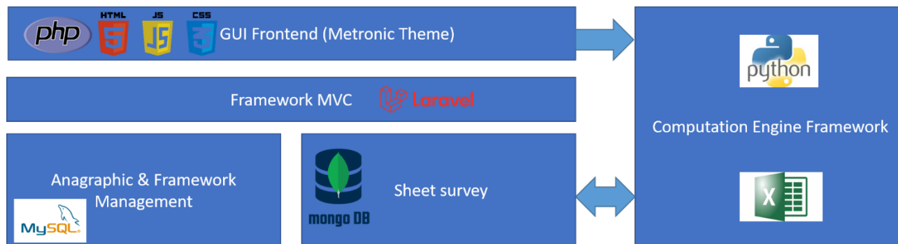
Figura 14: Architettura e stack tecnologico RECON
