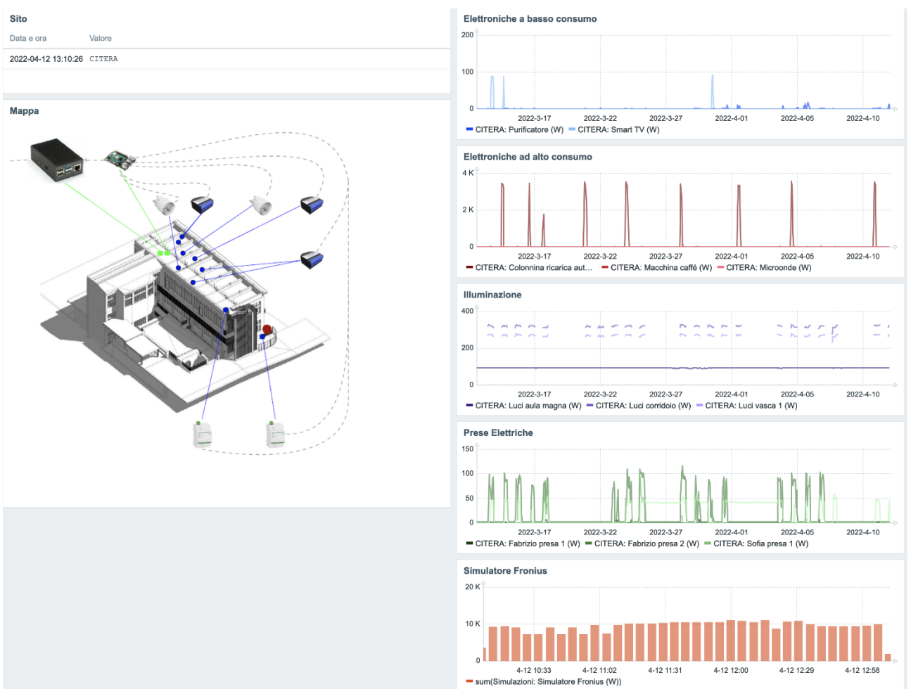
Grafico 3 Consumi dello smart lab in un mese (Aprile 2022) visualizzati su un cruscotto nel sistema Zabbix
