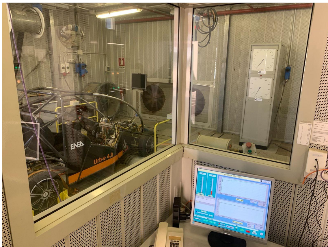
Figura 7 – Il banco a rulli durante i test con il veicolo elettrico URBE
