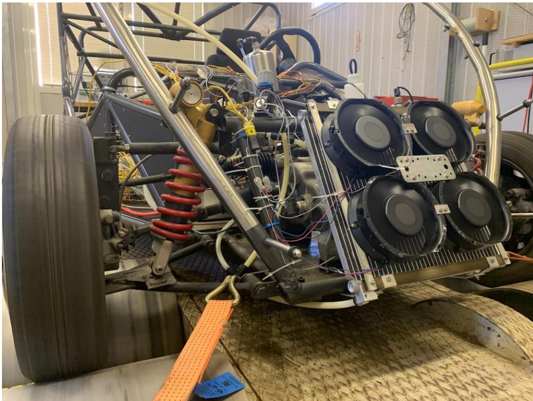
Figura 21 – Il veicolo elettrico URBE durante i test sul banco a rulli
