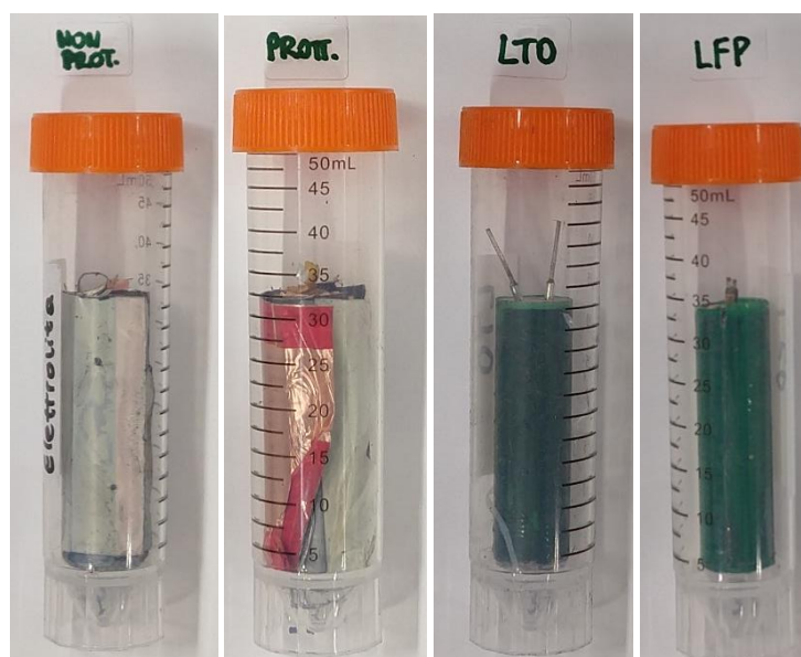
Figura 44. Immagine delle celle dopo rimozione del case: LNCA non-protetta, LNCA protetta, LTO e LFP
