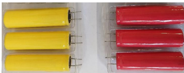
Figura 1. Immagine delle celle in esame: LTO (gialle) e LFP (rosse)
