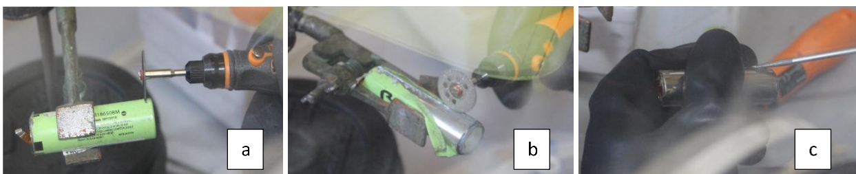
Figura 2. Rimozione tappi (a), rimozione alloggiamento plastico (b), rimozione dell'alloggiamento metallico
