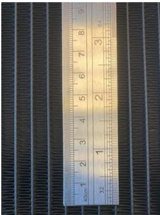
Figura 26. Particolari costruttivi delle alette di raffreddamento del condensatore
