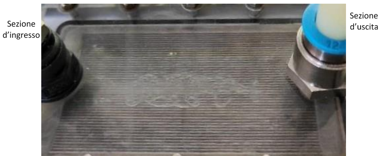
Figura 43. Inizio ebollizione forzata nell'evaporatore
