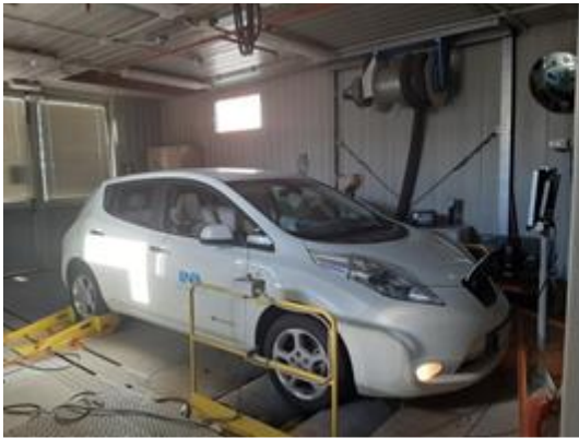
Figura 2: VE#2 all'interno del laboratorio contenente il banco a rulli dell'ENEA
