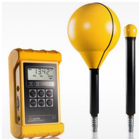
Figura 4: ELT 400 e le due sonde da 100 cm 2 e 3 cm 2
