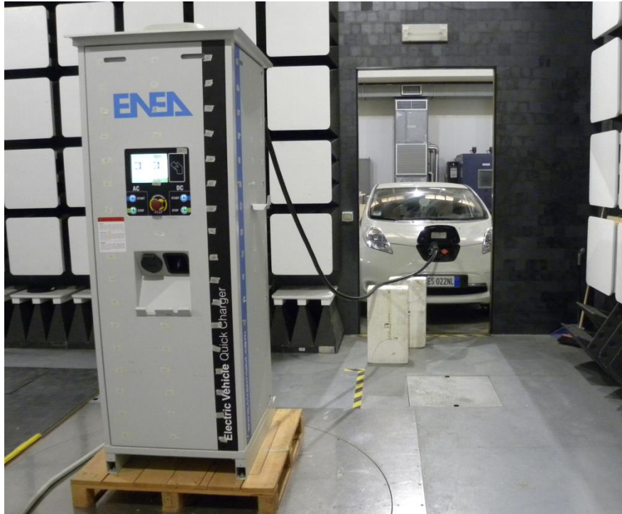
Figura 12: Posizionamento della stazione di ricarica e della auto in ricarica nella camera semi-anecoica
