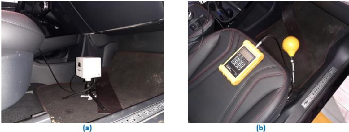
Figura 10: posizionamento dei sensori sul fondo dell'auto, a) EHP 50G; b) ELT 400
