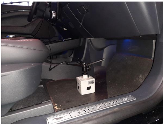
Figura 11: EHP 50G posizionato capovolto sul fondo anteriore dell'auto
