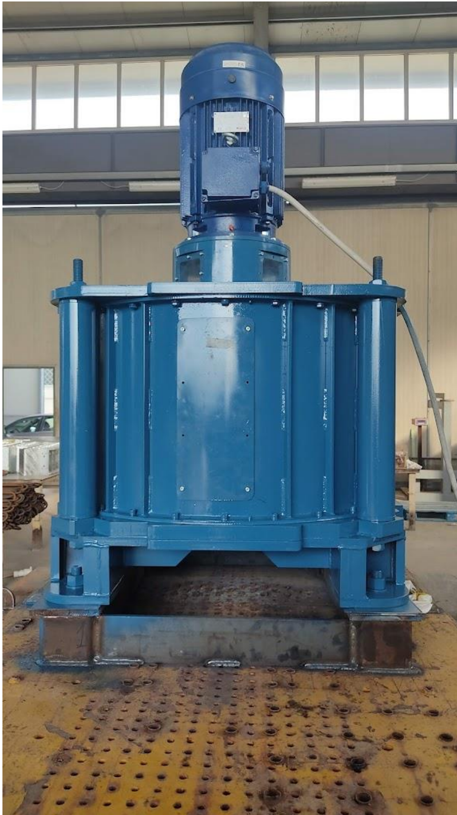
Figura 24: Il volano realizzato nel momento del collaudo
