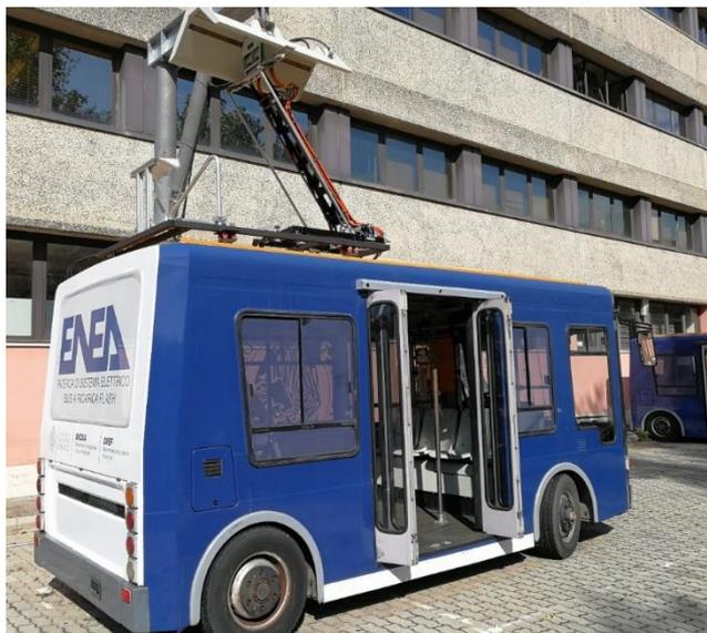
Figura 1: Vista del minibus durante la ricarica
