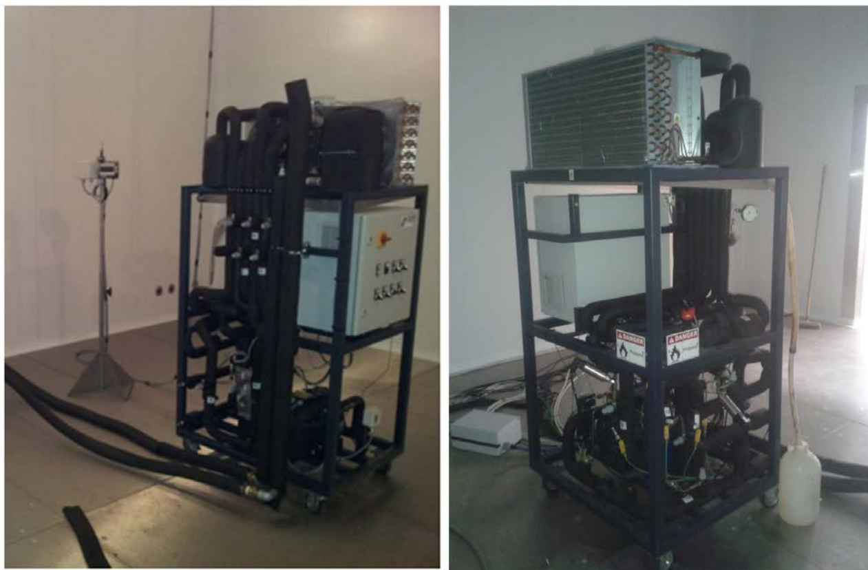
Figura 15: Vecchi prototipi delle pompe di calore installate in camera climatica (a destra la macchina a R290).
