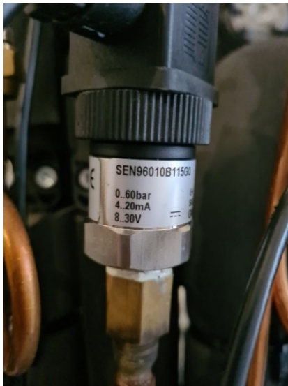
Figura 20: Sensore di pressione montato sugli impianti sperimentali a pompa di calore
