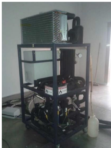
Figura 7.1. Batteria alettata Frigo System® CCV1470/4-T7.
