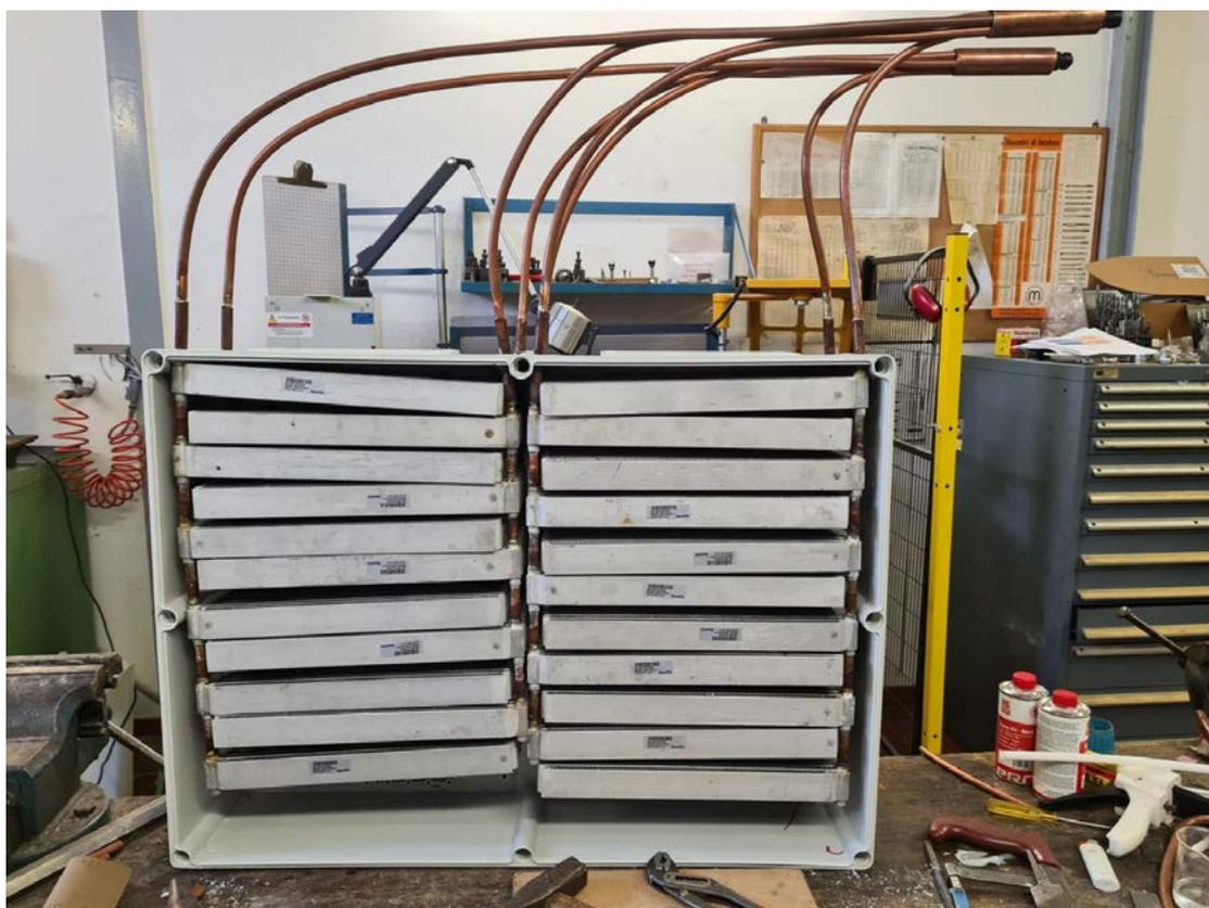
**Figura 105 – Assemblaggio degli scambiatori all'interno del contenitore del PCM**
