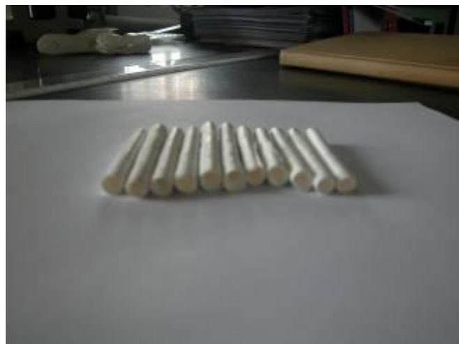
Figura 62- campioni sinterizzati prima del taglio
