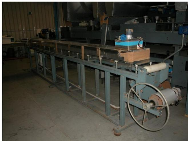
Figura 49 - Tape casting di laboratorio
