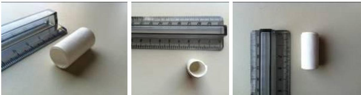
Figura 52. Supporti ceramici sinterizzati in figura il campione di allumina ( $Al_2O_3$ )
