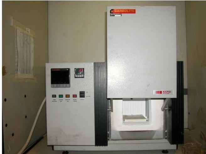
Figura 50 - Forno di calcinazione per materiali ceramici
