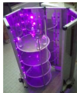
Fotobioreattore con illuminatore a LED
