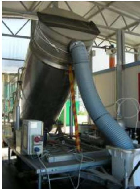
**Figura 1. Digestore anaerobico DMM2000**
