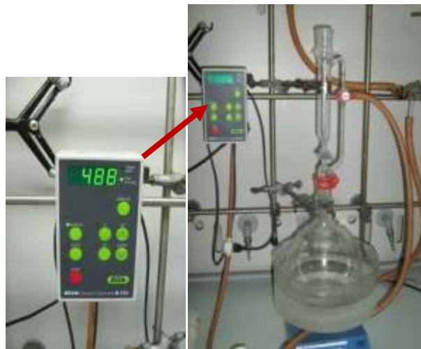
Figura 1. Apparato per la misura dell'assorbimento di CO 2 con un'ammina in un solvente non acquoso
