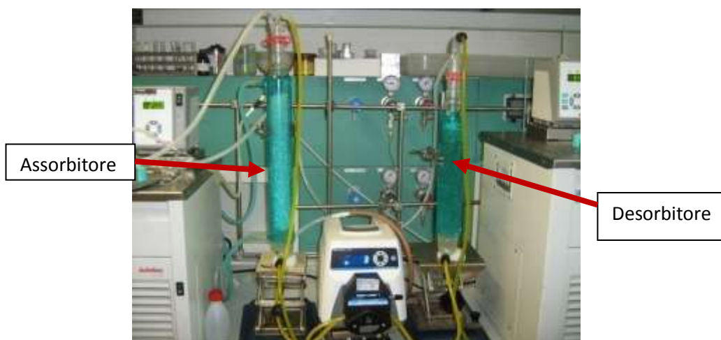
Figura 7. Sistema di assorbimento e desorbimento di CO 2 in continuo. La temperatura delle due colonne incamiciate è controllata mediante la circolazione di glicol etilenico termostattizzato
