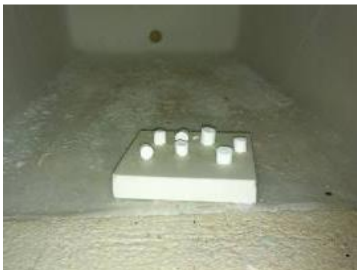
Figura 11. Fotografia dei pellets al termine della sinterizzazione
