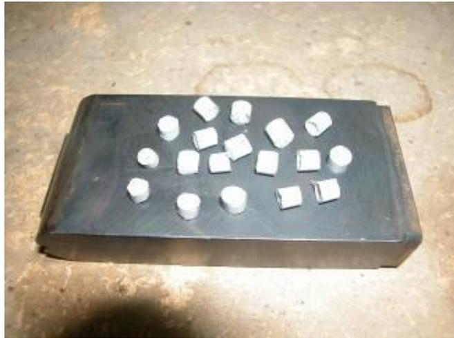
**Figura 6. Pellets in alfa allumina prima di essere messi in forno**
