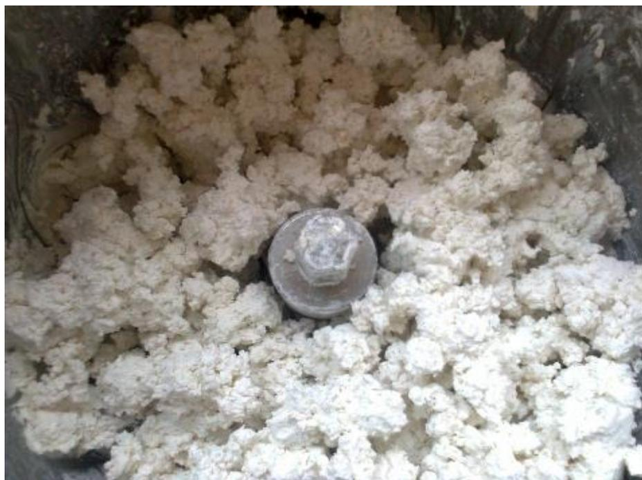
**Figura 15. Agglomerazione della polvere all'interno del turbo miscelatore dopo aggiunta della soluzione acquosa**
