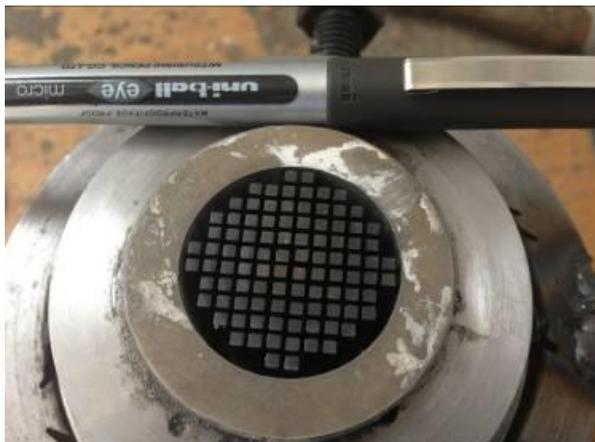
**Figura 13. Testa di estrusione**
