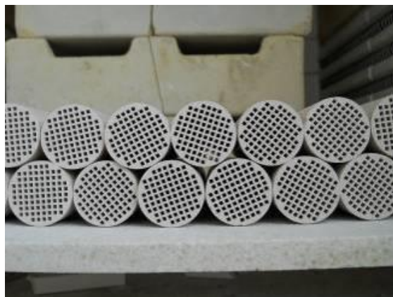
Figura 13. Posizionamento dei campioni nel forno per la pre-sinterizzazione
