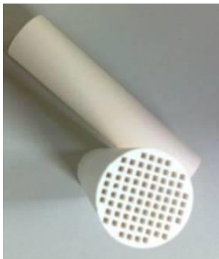
Figura 12. Campioni di filtro ceramico estrusi
