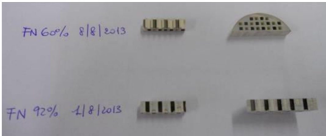
Figura 34. Immagini di campioni in Al 2 O 3 prima della metallizzazione
