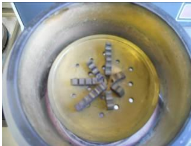
Figura 35. Immagine dei campioni in Al 2 O 3 dopo metallizzazione
