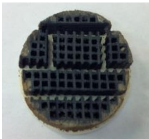
Figura 25. Esempio di sezione tagliata composta nei vari provini per analisi
