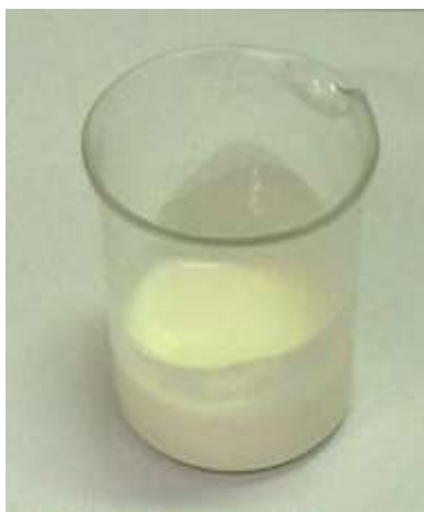
Figura 1. Washcoat diluito utilizzato per l'impregnazione
