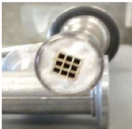
Figura 12. Monolite caricato nel reattore
