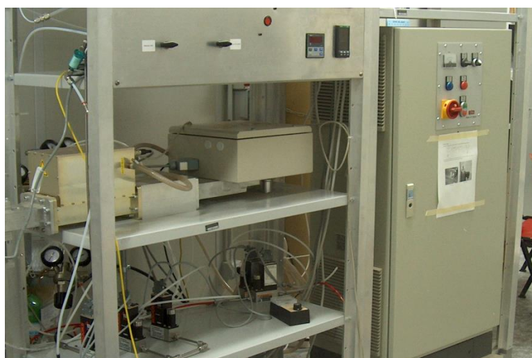
Figura 9. Generatore di microonde FMG 2,0kW della Fricke and Mallah Microwave Technology GmbH
