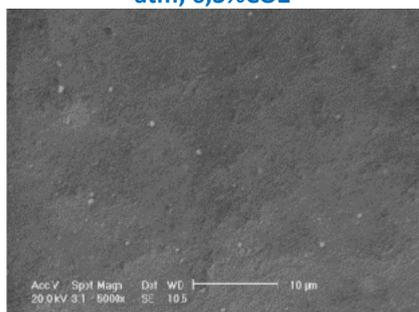
**Fig B.4.a:** Immagine SEM a grande ingrandimento HT1 dopo il test a T=600°C;P=1 atm; 6,3%CO2
