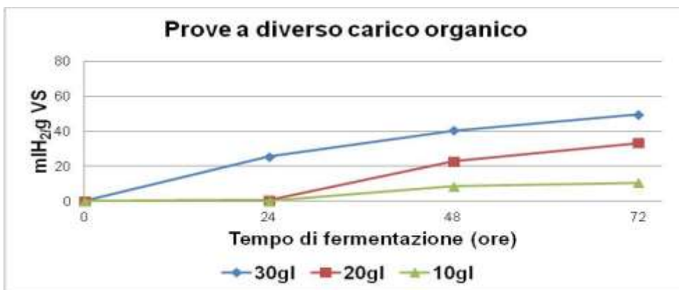
Figura 47 Prove a differente carico organico di scarti di insalata. Attenzione in legenda 30gVS/l; 20gVS/l e 10gVS/l
