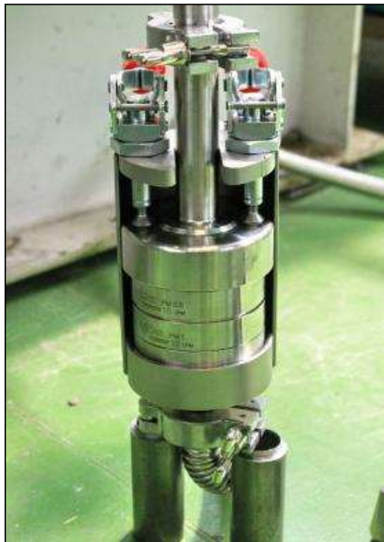
Figura 11. Impattore per la misura gravimetrica del particolato
