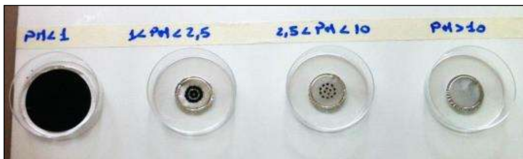
Figura 21. Filtri dell'impattore a seguito del campionamento (prova 23/07/2013)
