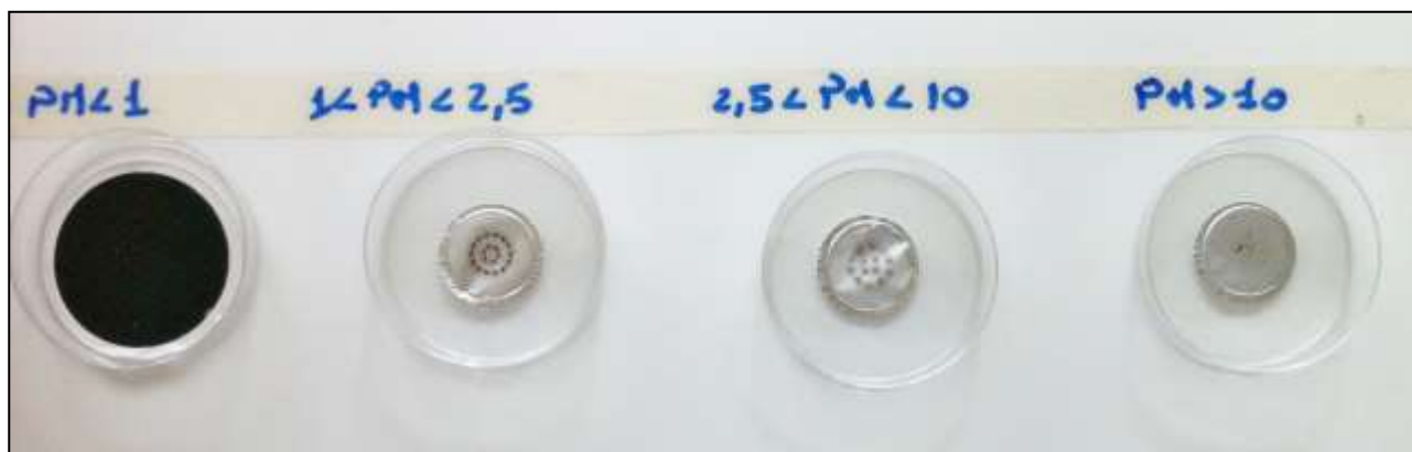
Figura 47. Filtri dell'impatto dopo la prova del filtro UniSA cat. 25% ad alta temperatura
