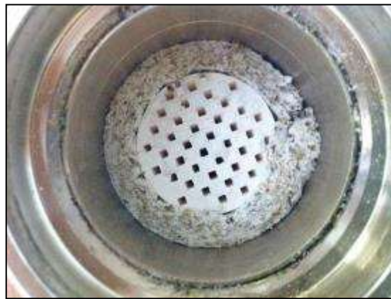
Figura 19. Filtro ceramico inserito nel manicotto
