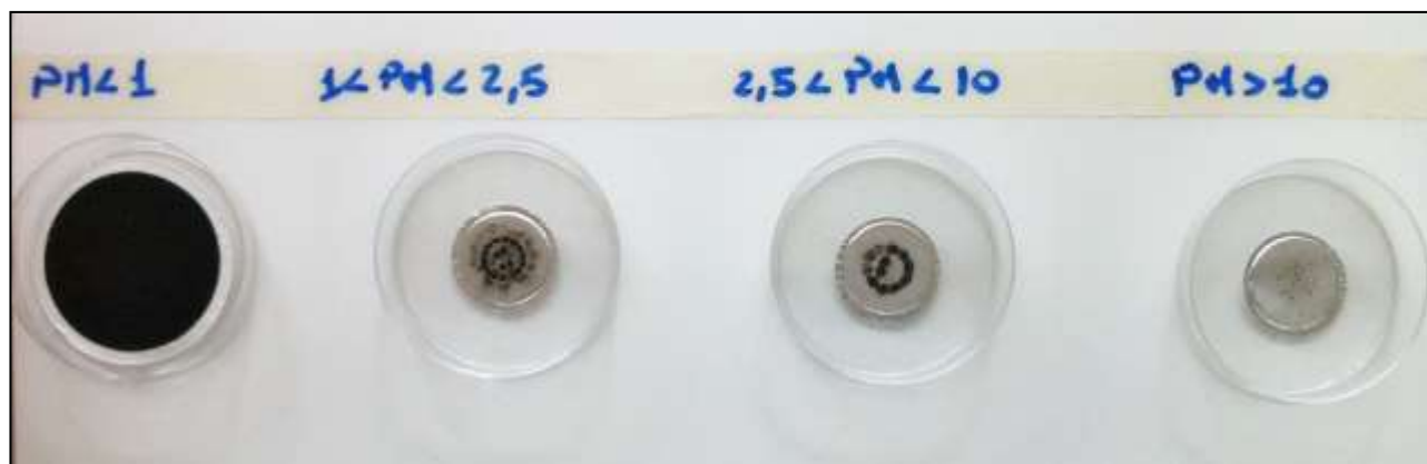
Figura 48. Filtri dell'impatto dopo la prova del filtro UniSA cat. 25% ad alta temperatura
