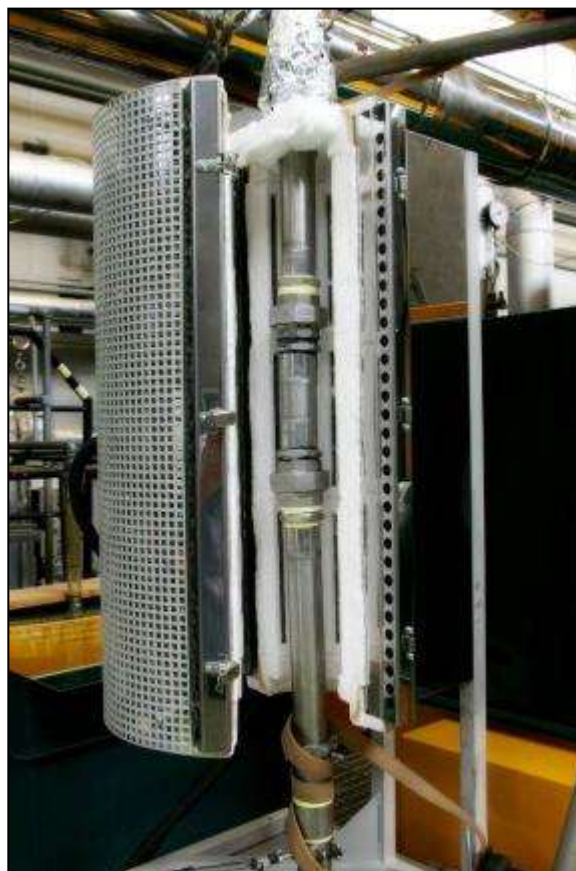
Figura 10. Colonna di derivazione dei fumi e forno tubolare
