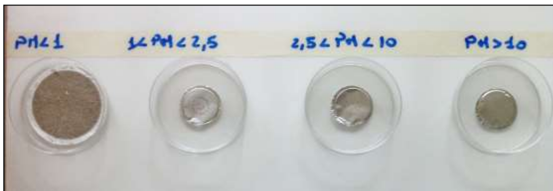
Figura 38. Filtri dell'impattore dopo la prova del filtro bianco UNISA a bassa temperatura
