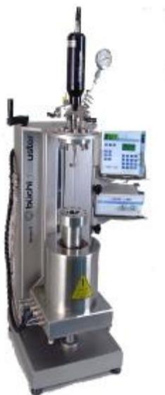
**Figura 4.1 Autoclave LIMBO II BUCHI utilizzata per il processo in condizioni subcritiche**
