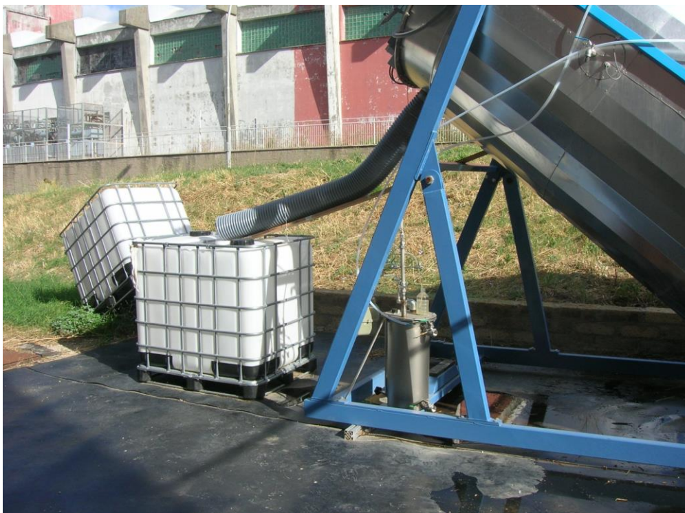
Figura 7. Scarico del digestato e guardia idraulica
