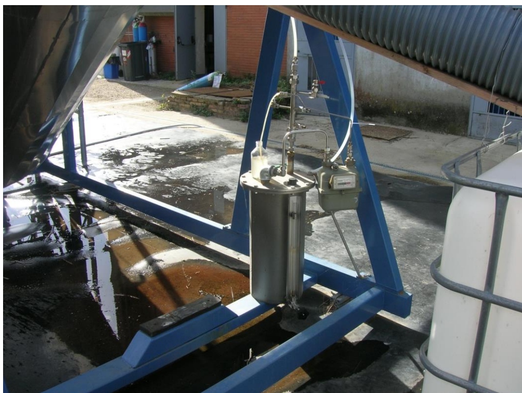
Figura 8. Contatore volumetrico del gas prodotto
