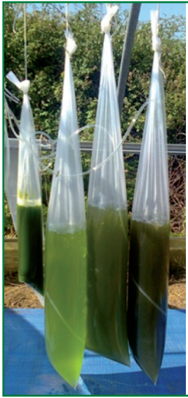
Fotobioreattore a sacco in stadi successivi di sviluppo e agitatore a pale posizionato in vasca di accrescimento di colture di microalghe
