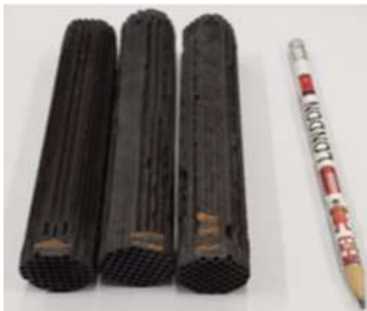
Figura 8: filtri realizzati per le prove allo scarico della caldaia in ENEA
