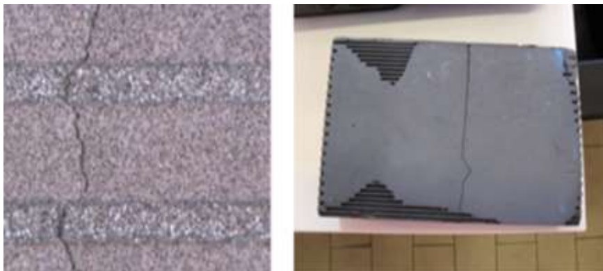
Figura 3: crepe originatesi per shock termico
