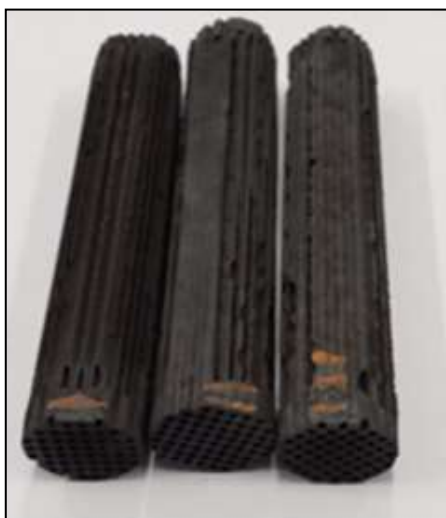
Figura 5. Prototipi in scala di laboratorio di filtri wall flow in SiC
