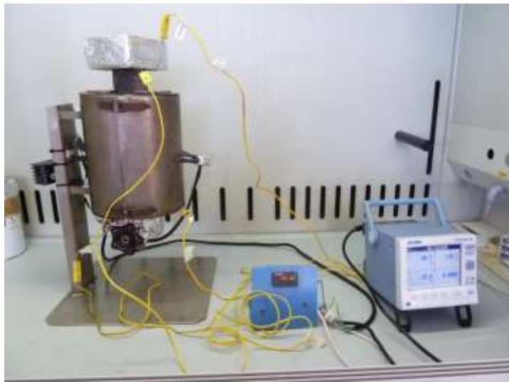
Figura 3. Sistema sperimentale per la misura della stabilità termica
