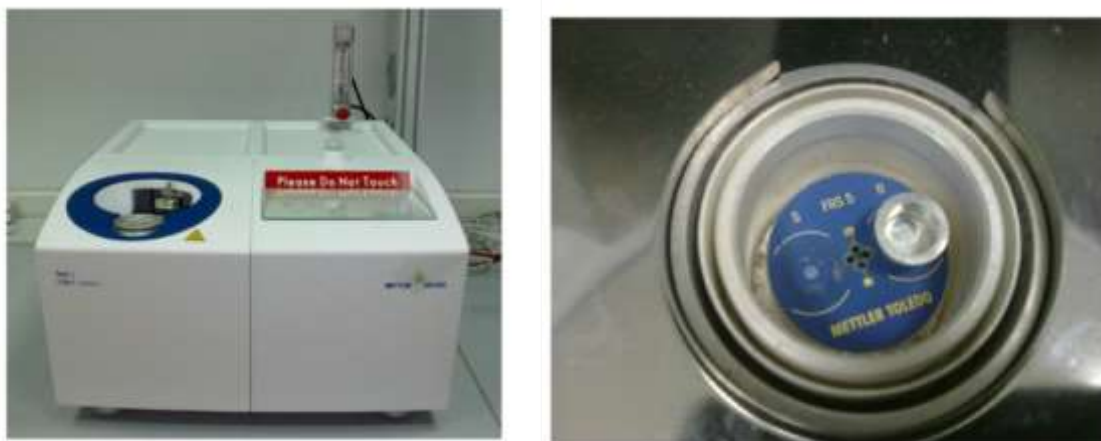
Figura 1. DSC - calorimetro differenziale a scansione e particolare del fornello contenente la zona per il campione ed il riferimento (crogiolo tappato vuoto)
