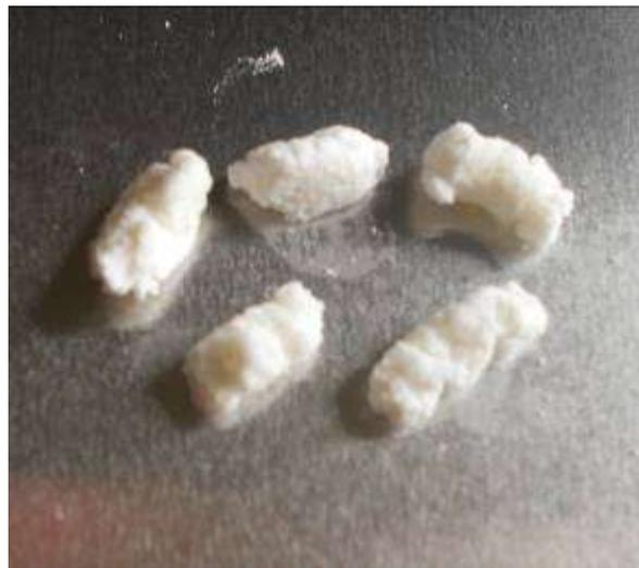
**Figura 10.** Forma ancora irregolare dei pellets realizzati
