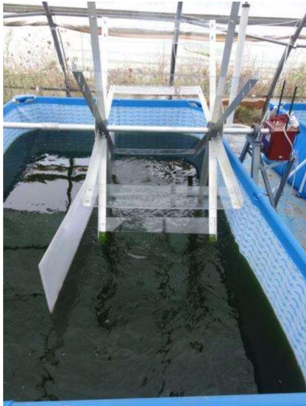
Figura 15. foto dell'agitatore a pale funzionante in vasca
