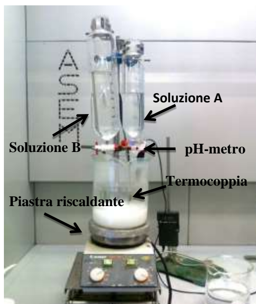
Figura 2. Sintesi dell'idrotalcite a pH costante
