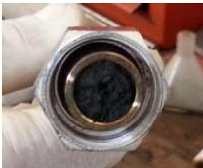
**Figura 5. Reattore di metanazione: dettaglio sul residuo carbonioso prodotto a fine prova con miscela 3**
