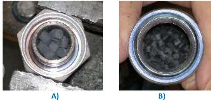
**Figura 9. Pellets di catalizzatore G1-85 a fine test con miscela di gas 5: A) all'uscita del reattore di metanazione, B) campione per le caratterizzazioni analitiche sull'integrità del catalizzatore.**
