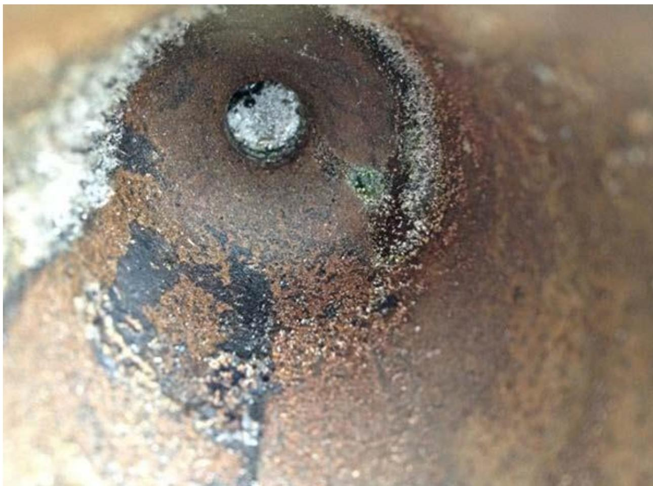
Figura 14 Particolare della superficie interna del cilindro dopo il taglio
