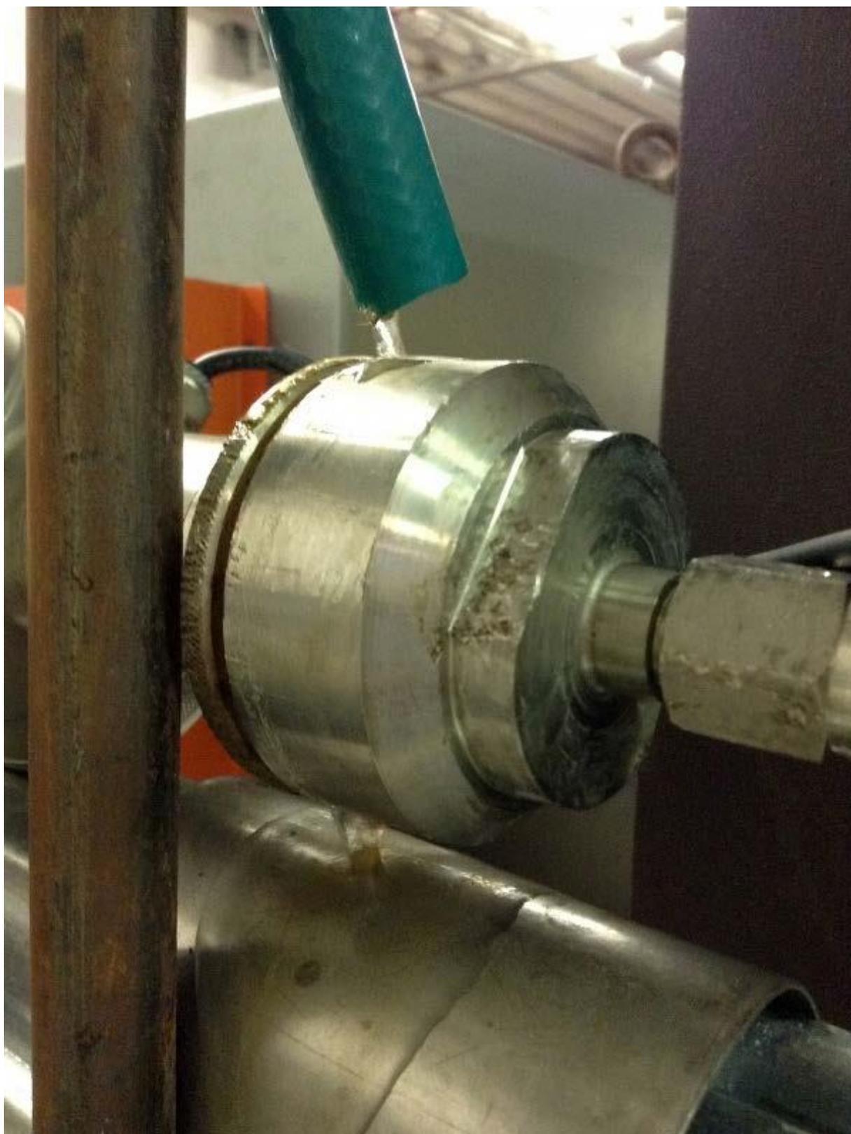
**Figura 15** Il sistema allestito per il raffreddamento della sezione di connessione al circuito del trasmettore di pressione TP2
