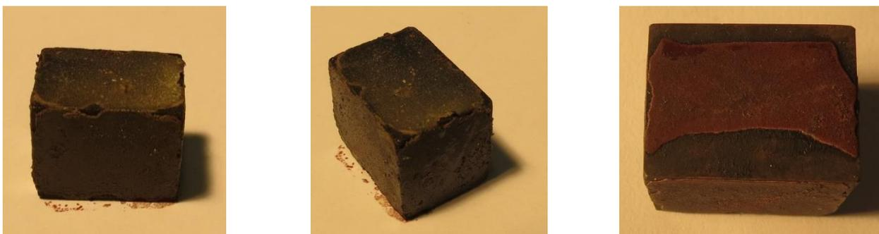
Figura 30 Diverse prospettive del parallelepipedo di P91 introdotti nel cilindro di prova con  $TiCl_4$  fino a 500°C
