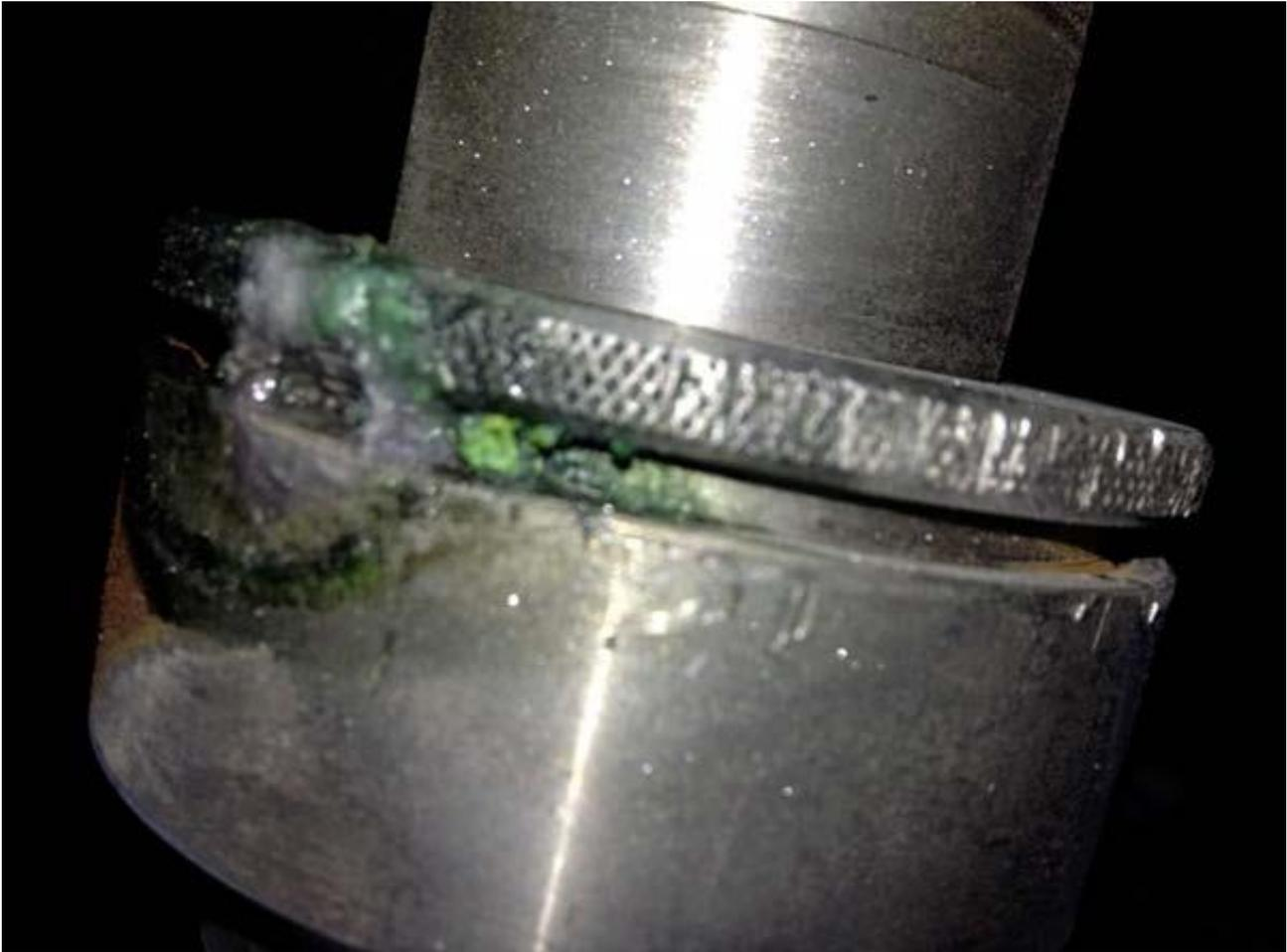
**Figura 13 Evidenza di fuoriuscita di fluido sul trasduttore di pressione TP2**
