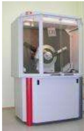
Figura 1. Diffrattometro Brucker D8
