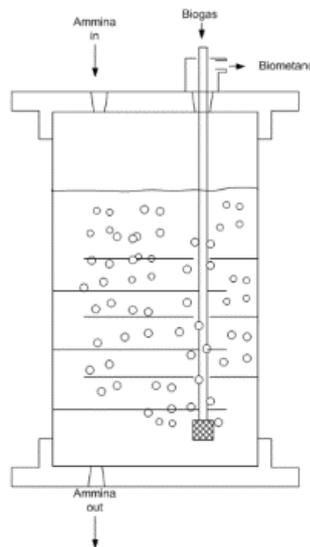
Figura 8. Schema serbatoio di assorbimento/desorbimento della CO<sub>2</sub>
