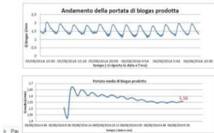
Figura 2. Andamento medio della portata di gas prodotta dal digestore pilota DMM6000
