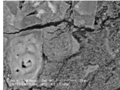
Figura E.24: Immagine SEM ingrandimento (2000X) HT1K dopo calcinazione 500°C per 8 h lappato per 2 volte
