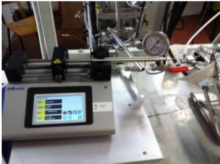
Figura 15. Pompa a siringa KDS Legato 110
