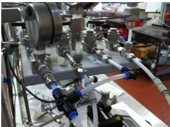
Figura 14. Dettaglio linea di alimentazione gas
