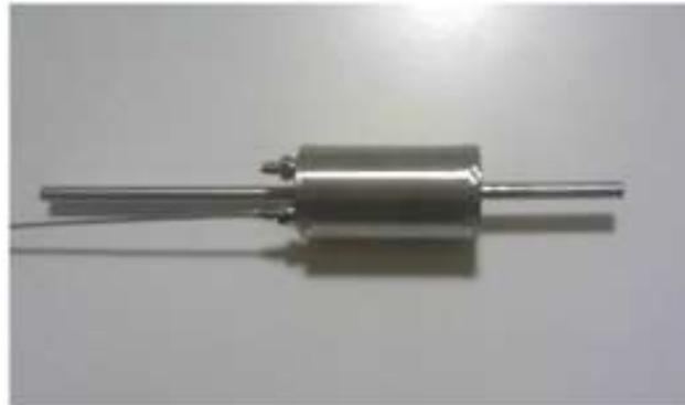
**Figura 19. Immagine dell'evaporatore prima della messa in funzione (Poliandri 2014)**
