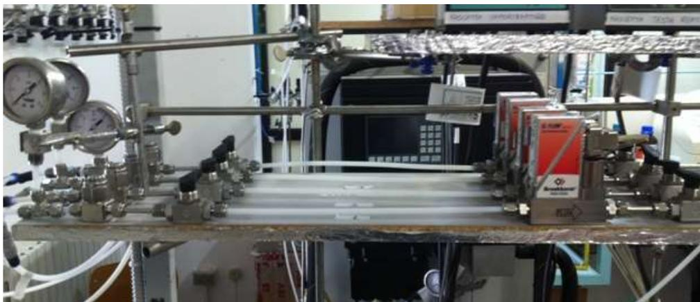
Figura 13. Linee di alimentazione dei gas
