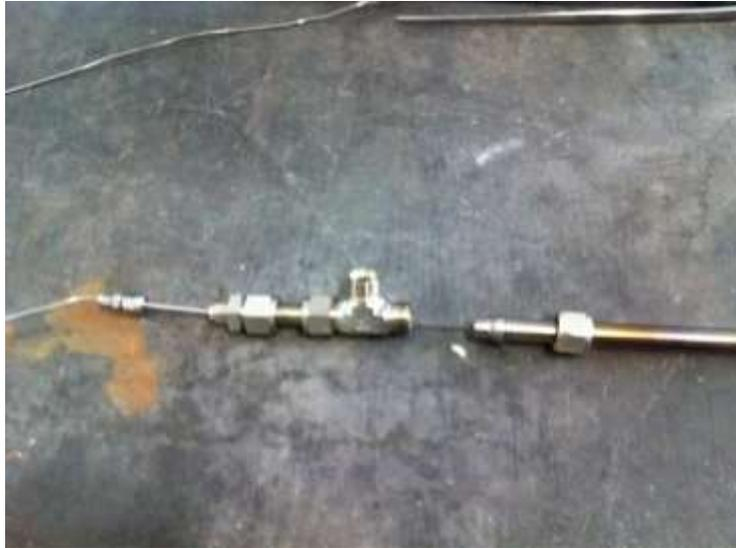
Figura 16. Dettaglio raccordo microreattore termocoppia resa passante
