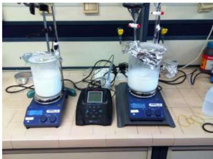
**Figura 7. Sintesi di idrotalcite a pH costante**
