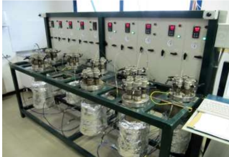
Figura 2. Sistema sperimentale (crogioli di acciaio INOX tracciati e rispettivi controllori di temperatura) utilizzato per le prove di compatibilità fra la miscela ternaria \text{NaNO}_3/\text{KNO}_3/\text{LiNO}_3 18/52/30 (p%) e gli acciai SS 316 L e SS 430
